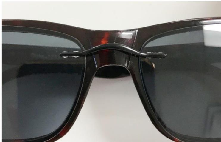
*\* LES TROUS DU PONT DOIVENT SE TROUVER À UNE DISTANCE COMPRISE ENTRE 2,5 MM ET 2,7 MM DE LA ZONE NASALE POUR EMPÊCHER LA FISSURATION DES VERRES. \* LES TROUS DU POINT SONT ESPACÉS DE 3 MM*
